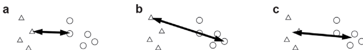
Obr. 18-1 Schématické znázornění způsobu měření vzdálenosti (nepodobnosti) dvou skupin objektů při užití metody: a - single linkage (jednospojné), b - complete linkage (všespojné), c - average linkage (středospojné).
